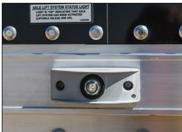
Figure 24 – Voyant et autocollant du système d'essieu relevable
