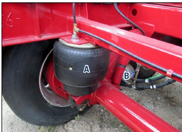
A – Coussin pneumatique B – Amortisseur Figure 35 – Coussins pneumatiques (type)
