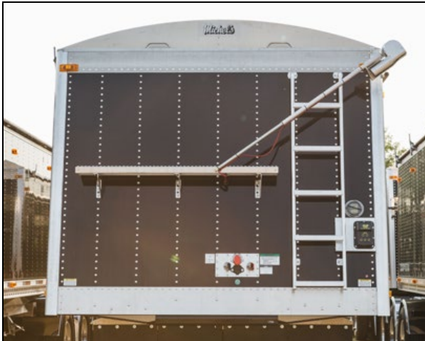
Figure 25 – Moteur électrique de la bâche
