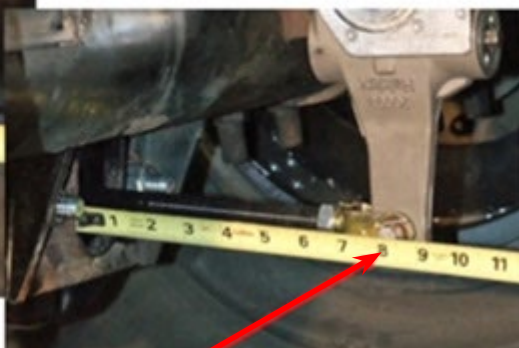
Prendre la mesure de la biellette actionnée entre 620 et 689 kPa (90 et 100 lb/po 2 ). Soustraire ces deux valeurs. La différence obtenue correspond à la course.
