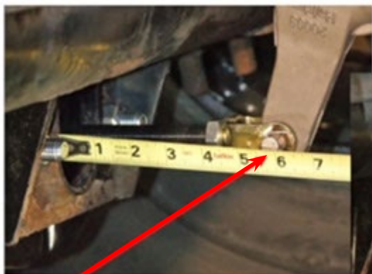
Prendre la mesure de la biellette à l'état desserré.
